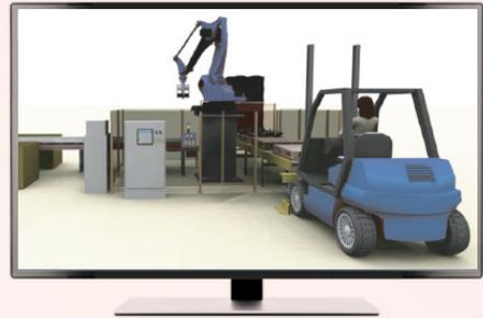
**Snap-Funktion:** Durch die Snap-Funktion bei der Modellerstellung ergeben sich automatisch lauffähige Modelle, die sich dann in einer zweiten Stufe bei Bedarf hinsichtlich der Materialflusssteuerung weiter detaillieren lassen.
