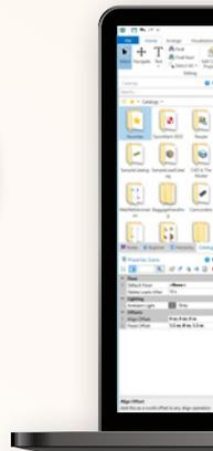
Die Bewegungsachsen werden dabei über vorgefertigte Funktionsbausteine den Bauteilen direkt aufgeprägt, womit sich dann auch komplexe Kinematiken animieren lassen. Die Kinematisierung von Daten mittels des „CAD Is The Model“ Moduls kann innerhalb von **Demo3D** aber auch in den Konstruktionsprogrammen direkt erfolgen, wofür spezifische Add-Ins zur Verfügung stehen.
