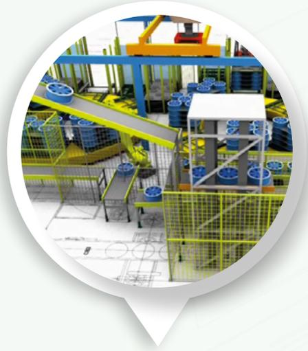
**Foto:** Simulationsmodell eines Reifenmontage, -sortier und -puffersystems
